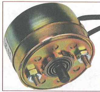
Bild 4: Ein um 80° rechtsdrehender Drehmagnet mit zwei M4-Befestigungsbolzen frontseitig, wobei eine Spiralfeder nach Abschlachten der Versorgungsspannung für die sichere Rückstellung in Ausgangsposition sorgt
