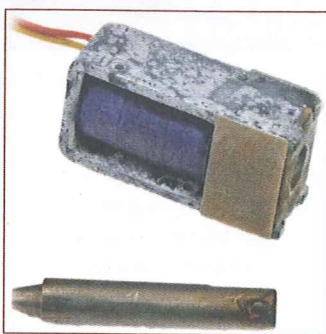
Bild 11: Bei diesem monostabilen Bügelmagnet ist nach fünf Monaten Einsatz in einem Kiesquetschwerk die Oberfläche bereits deutlich angegriffen. Dafür verantwortlich ist eine hohe Luftfeuchte in Verbindung mit aggressiven Zuschlagstoffen.
